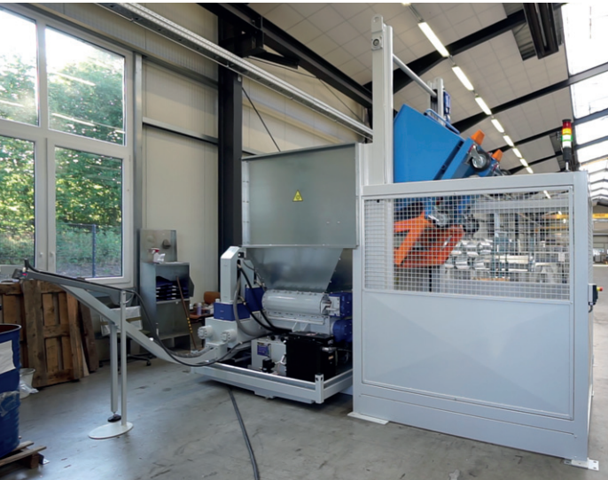
Lift/kantel installatie voor het geautomatiseerd invoeren van containers.
